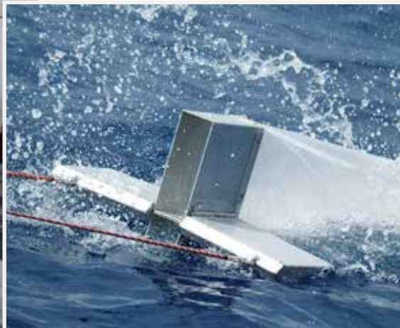
Fig. 7. Med et mantatrawl kan der i havets overflade indsamles prøver af mikroplastik ned til 1/3 mm i størrelse. Dette giver ny viden om mikroplastikkens omfang, udbredelse og typer i havet. Foto: Claudia Sick
