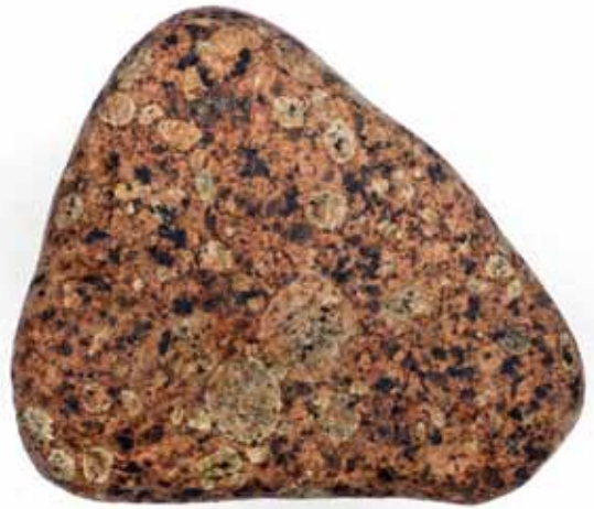
Fig. 5b. Ålands-rapakivi med lyse ringe (Plagioklas forvitret = kaoliniserer lettere end kalifeldspat). Foto: Sven Madsen.
