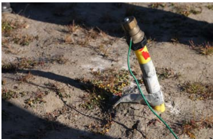
Fig. 3. Borehul til temperaturmåling.
