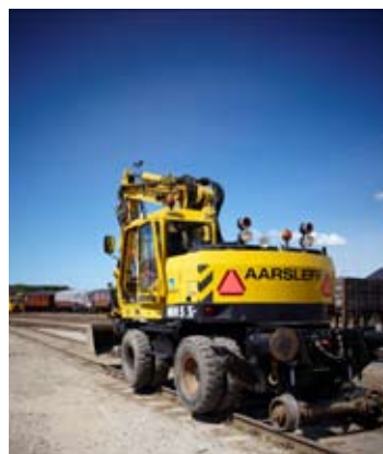
Figur 5. De kommende år byder på udbygning og opgradering af jernbanen flere steder. Bane-vej maskiner a la denne bruges til gravearbejde i forbindelse med sporformyelse. Foto: Kirsten Mengel.
