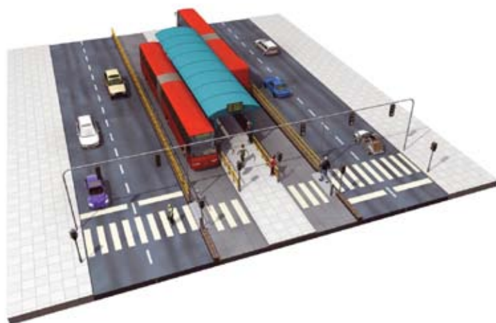
Figur 4. Højklassede bussystemer har stoppesteder med kvalitet som en station.
