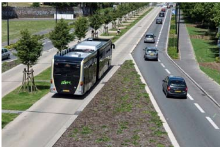
Figur 5. Bus-Rapid-Transit busser helt i eget tracé – bane på gummihjul.
