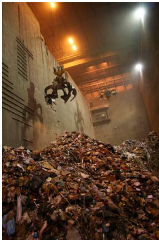
Figur 2. Styringen af forbrændingsprocessen begynder i affaldssiloen, hvor det forbrændingsegnede affald blandes af tre kraner, der kører automatisk. Foto: Vestforbrænding.
