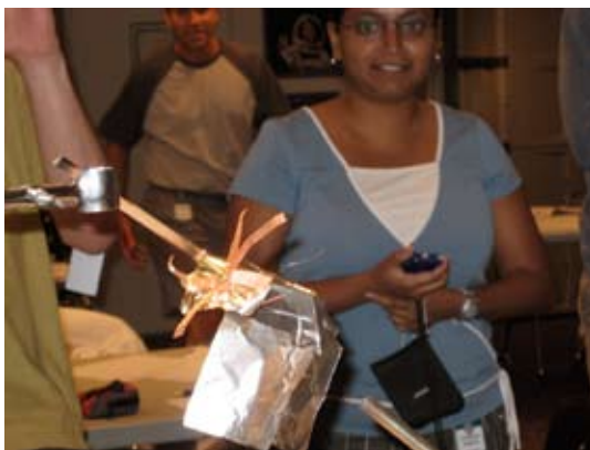
2: Her ses en forbedret model. Dels er der 2-3 lag aluminium og yderligere er kobberet klippet op og samlet i en stjerne for på den måde at sprede varmen mest muligt - igen med det formål, at skruen ikke må blive varm, så limen smelter og skruens tag i dyvelen slippes. Foto: Birgit S. Justesen.
