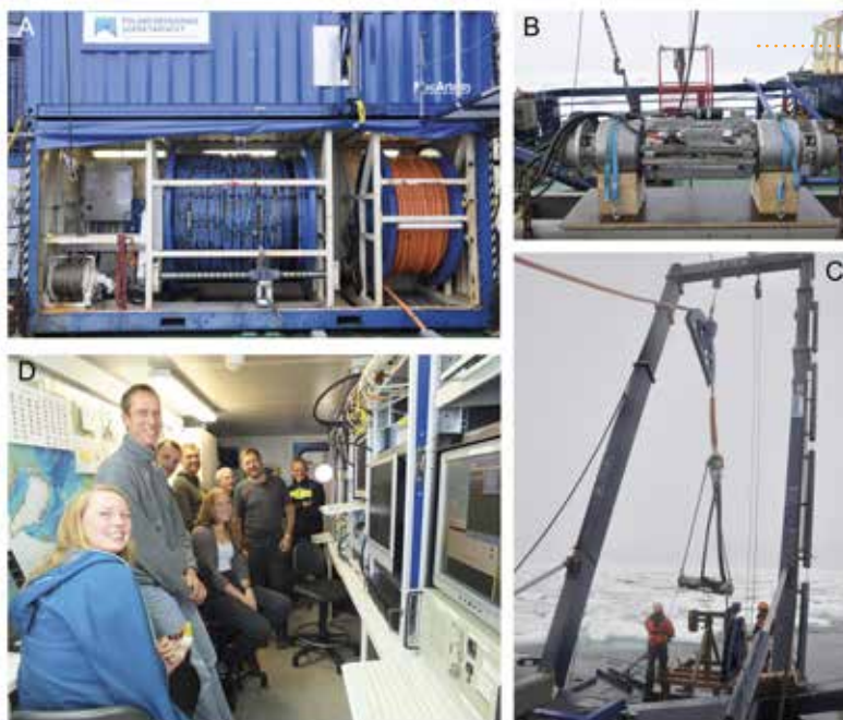
Fig. 6. Det seismiske udstyr brugt under LOMROG togterne og udviklet i samarbejde med Institut for Geoscience ved Aarhus Universitet. Alt udstyr er monteret i containere: (A) Container med spil for det seismiske lyttekabel (i midten) samt det kabel (orange), der forsyner lydkilden i form af luftkanoner med trykluft samt er signalkabel til lyttekablet, (B) seismisk luftkanon, (C) søsætning af luftkanonen og (D) det indre af registreringscontaineren, hvor det seismiske signal registreres, behandles og lagres sammen med navigationsdata og andre data. Fotos: Thomas Varming (A, B og C) og Marie Lykke Rasmussen (D))
