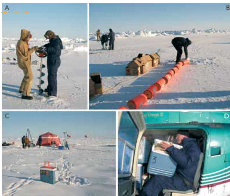
Fig. 8. Fotos fra LORITA ekspeditionen, der viser forskellige aspekter af de refraktionsseismiske undersøgelser på havisen i foråret 2006: A – et hul bores i havisen, B – eksplosiver sænkes ned igennem hullet til en dybde af ca. 100 m og gøres klar til sprængning, C – seismometer (lytteinstrument – aluminiumscylinger) ved siden af dataregistrerings-instrumentet, der befinder sig i en "køleboks" for at holde på varmen, D – efter at sprængningerne er udført indsamles seismometrene, der har været placeret med en indbyrdes afstand på ca. 1,5 km, ved hjælp af helikopter. Foto: Ron Verrall (D)
