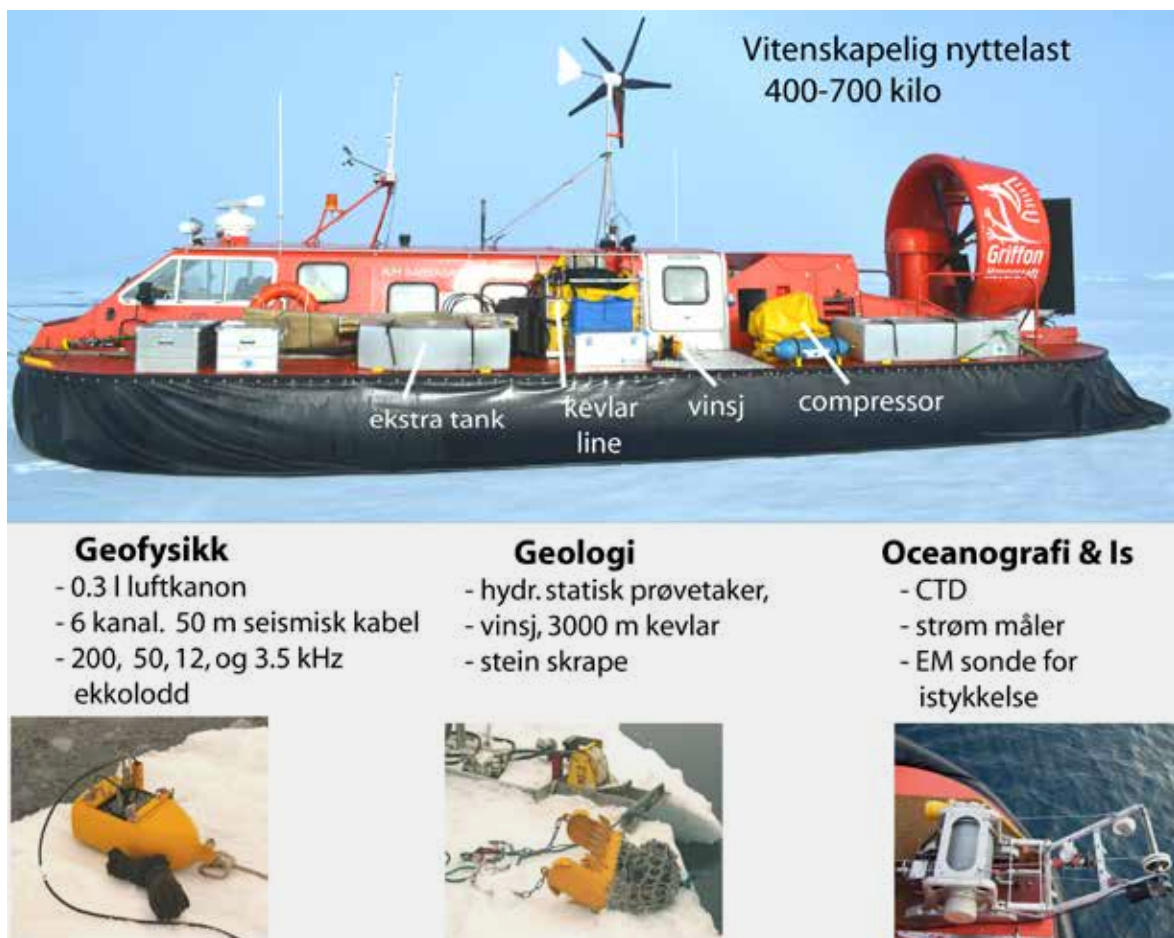
Fig. 2. Luftpudebåden Sabvabaa med moderne forskningsudstyr. Fartøjet er 11 meter langt, seks meter bredt og er udstyret med en 440 hk motor. Svævehøjde er 0,7 meter.
