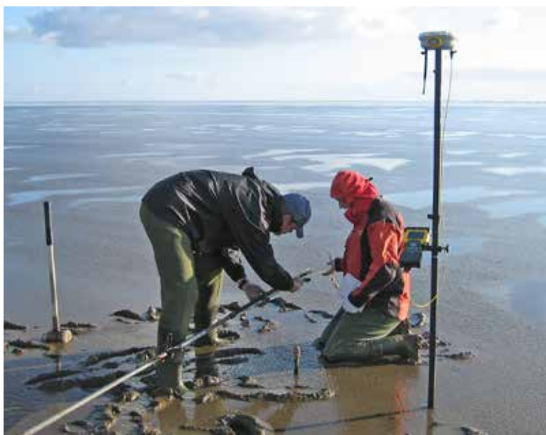
Fig. 2. Tidevandsfladens sedimenter undersøges med et håndbor, og sedimenterne beskrives. En GPS bruges til at bestemme borestedets position samt tidevandsfladens kote. Foto: Lasse Haarder Kirkegaard
