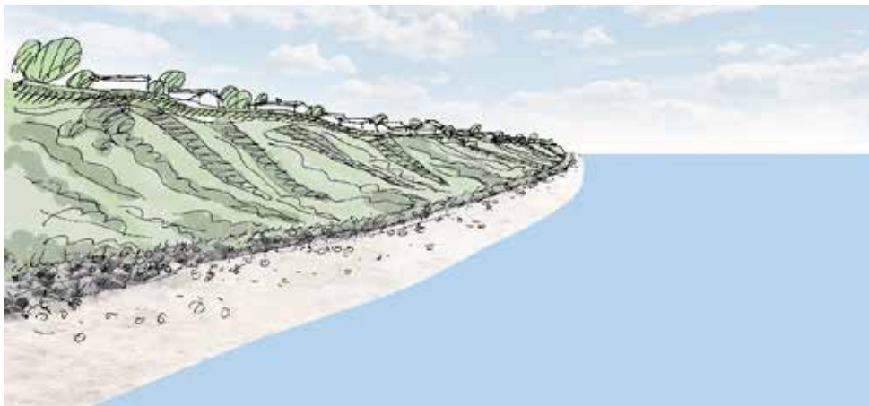
Fig. 4. Illustration af en kyststrækning efter strandfodring. Halsnæs, Gribskov og Helsingør kommuner (2016). Nordkystens Fremtid – Kystteknisk Skitseprojekt.
