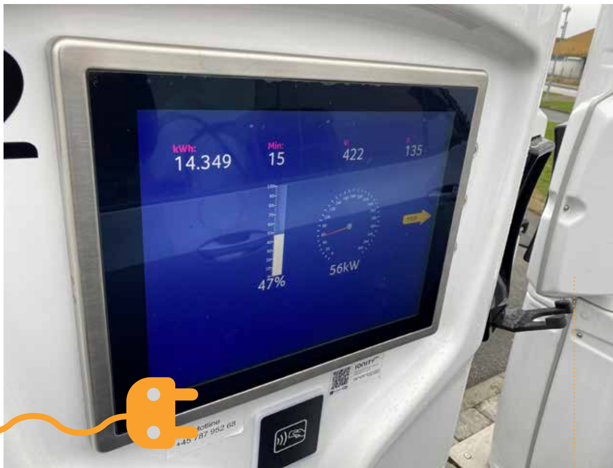
Ladestation med igangværende opladning af elbil. Med en ladeffekt på 56 kW som her, kan der oplades 100 kilometers rækkevidde på ca. 15 minutter (afhængig af den aktuelle elbils forbrug/effektivitet).
