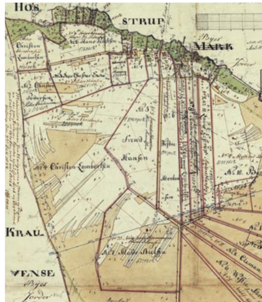
Figur 6: Del af Original 1 kort over Kokspang nord for Esbjerg. Som grundlag er brugt et originalt udskiftningskort fra 1785/86 – bebyggelse, eng og hede er smukt farvelagt. Både udskiftnings- (normalt overstreget) og matrikuleringsoplysninger er med på kortet, så det kan være svært at håndtere for en urutineret. Angivelserne af det dyrkede område kan være svært at overskue i Vestjylland, for et område kunne godt blive dyrket i 2-3 år for så at ligge i hede i 20 år (f.eks. "gammeljord"). Men her ses til gengæld nyopdyrkning af hede, nærmest ved at bønderne konstant har pløjet lidt længere ud hvert år på tjenlige stykker. ©Kort & Matrikelstyrelsen (A. 103-03).
