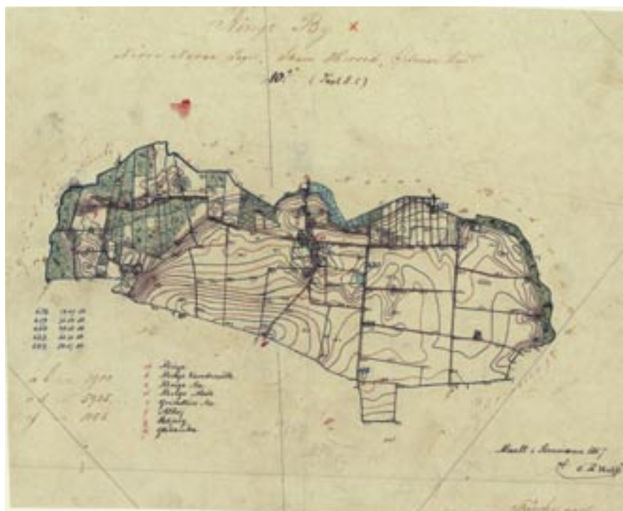
Figur 3: Bymåling (byblad) 1867 for Ringe ved Sdr. Nærå, Fyn. Disse lidt uanse- lige målinger ligger til grund for de danske kortværker i slutningen af 1800- tallet og et stykke op i 1900-tallet. De indeholder oplysninger, som ikke findes i de trykte kort, bl. a. mere fintma- skede højdekoter og ofte et bedre navn- nestof – f.eks. har galgebakkerne en tendens til ikke at komme med, måske pga. en anden hold- ning, da kortene skulle trykkes nogle år senere. ©Kort & Matrikelstyrelsen (A. 103-03).
