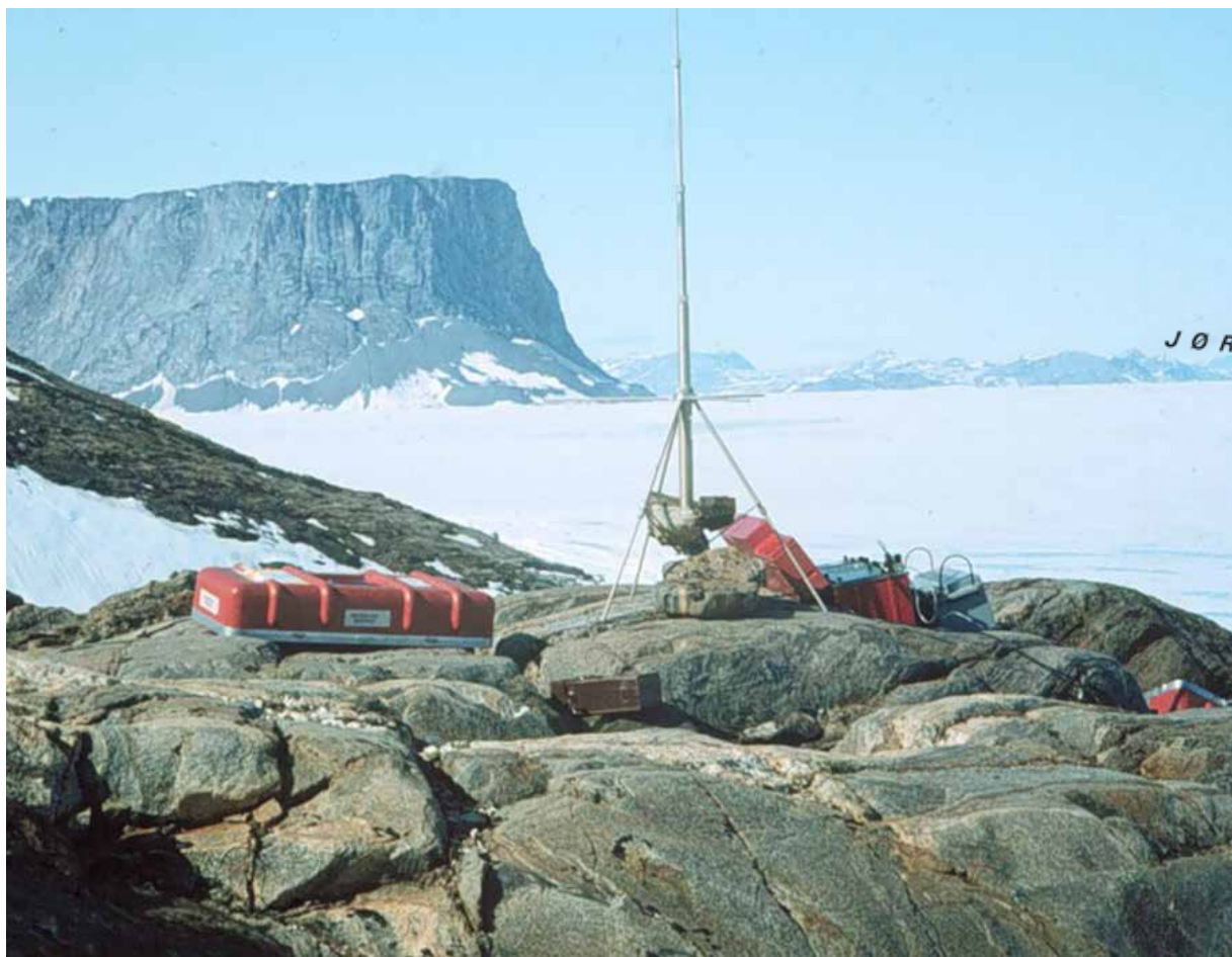
Billede af JMR-1 Doppler instrument med Kap Amalie i baggrunden. Til højre ses låget til instrumentet, som står til højre for antennen. Instrumentet står fast ved hjælp af nogle sten på instrumentfoden. Batteriet er den grå firkantede "klods" til højre for instrumentet.
